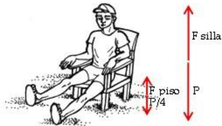
Figura 16. Persona sentada en una silla sobre un piso de lodo. Debido a que hay en toda interacción pares de fuerzas, la persona permanece en la silla y la silla se hunde un poco en el piso.
