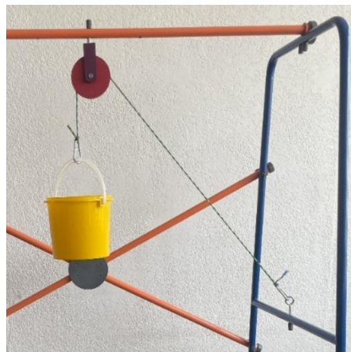
Figura 37. Izquierda: Montaje de la polea fija por donde pasa la cuerda que sostiene la cubeta. Derecha: El cordel se ha fijado a un lado del soporte para mostrar el montaje. (Elaboración propia)
