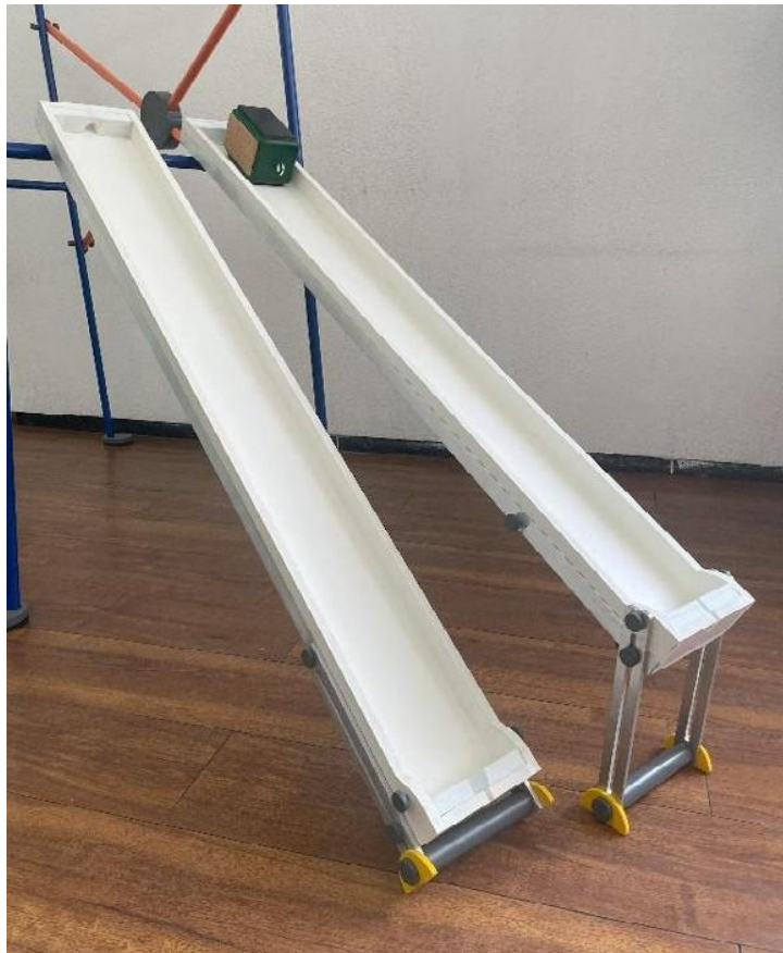
Figura 30. Dos rampas a diferentes inclinaciones sobre las que se puede deslizar el bloque. (Elaboración propia)
