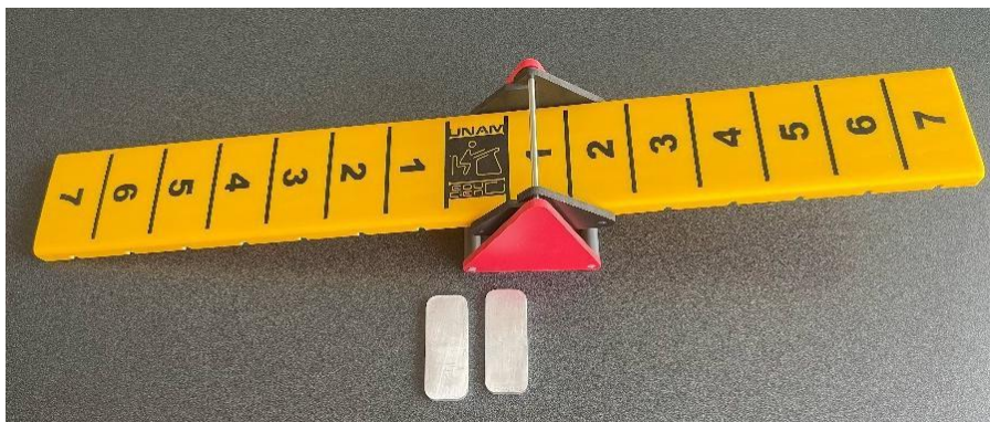
Figura 32. Balanza con el fulcro de giro desplazado una casilla. (Elaboración propia)
