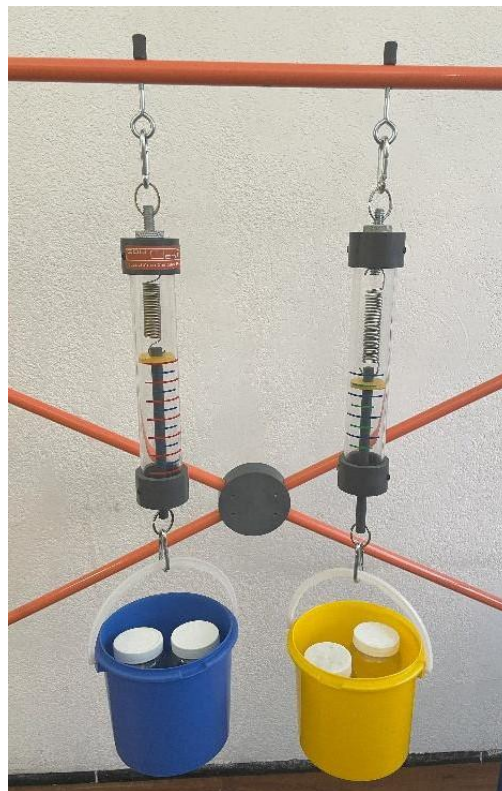
Figura 33. Los dinamómetros colgados del travesaño superior del marco cargan las cubetas con pesos. (Elaboración propia)
