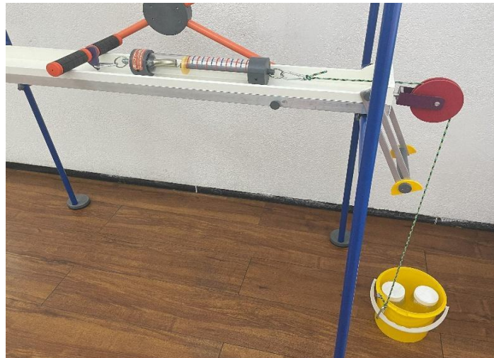
Figura 34. El dinamómetro sobre la superficie horizontal jala la cubeta por medio de una cuerda que pasa por la polea. (Elaboración propia)
