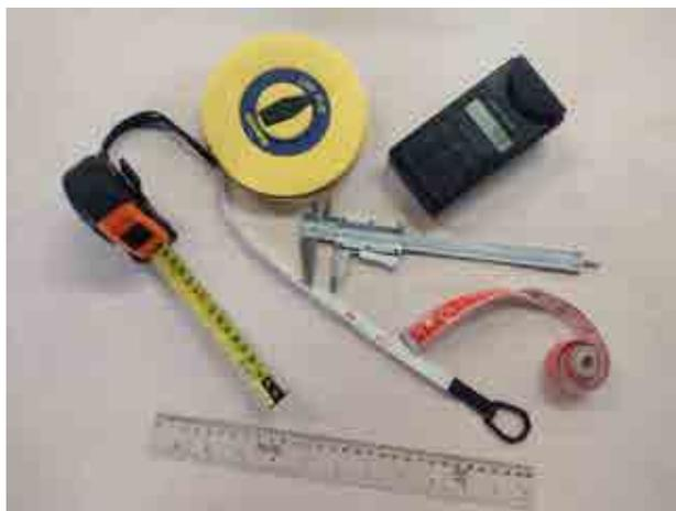
Figura 4.1. Instrumentos para medir longitudes o distancias:
